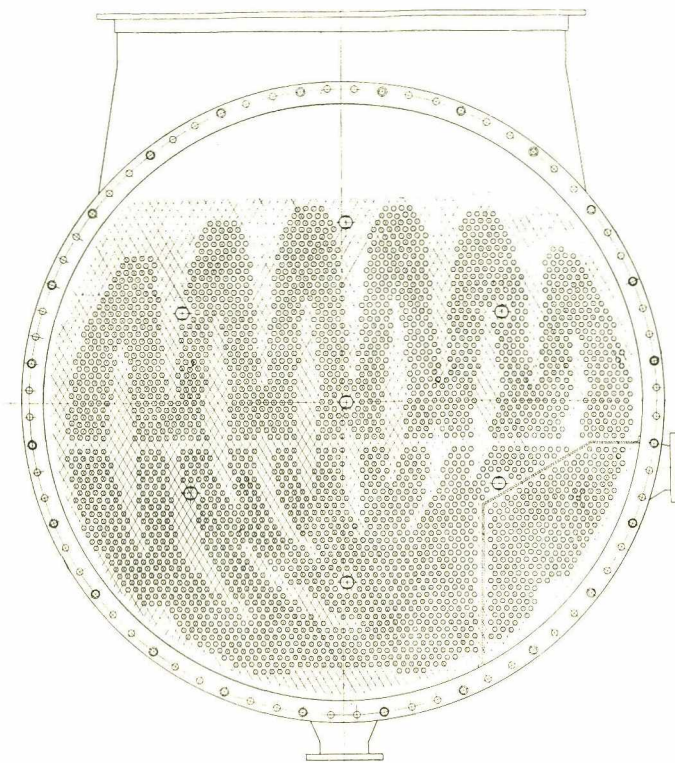
Fig. 7. — Coupe d'un condenseur par surface Bréguet.
